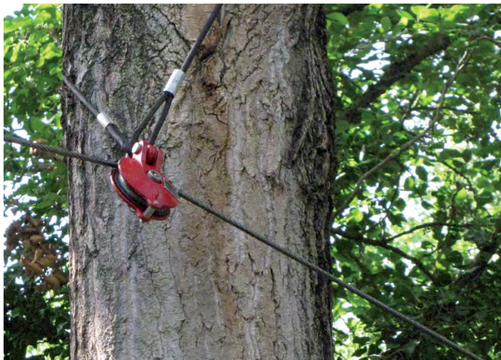
Figura 18 - Particolare di controventatura della linea di esbosco (Foto di Leonardo Rescic).
